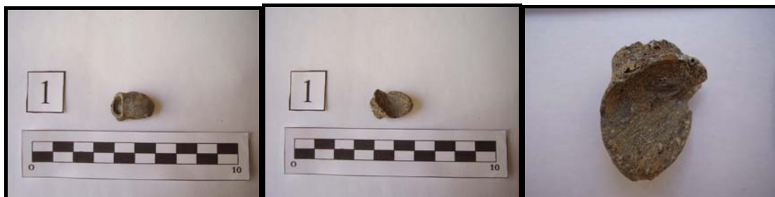
Bala de pistola 1, deformada por impacto. Bala de pistola 1, zona de impacto. Detalle del impacto en la bala de pistola 1.
