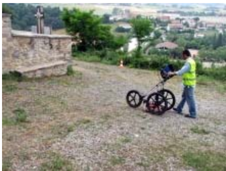
El georradar ayuda a verificar la presencia de restos osteológicos antes de la excavación (Imagen cedida por L. Alvial)
